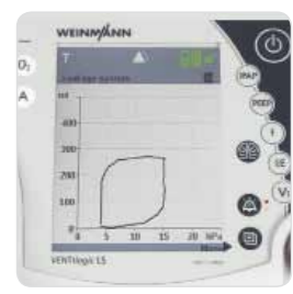
Bucle de presión/volumen con escalamiento automático de ejes
