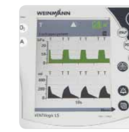
Curvas de presión y volumen con escalamiento automático
